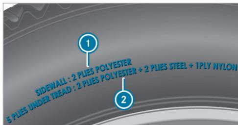
**i** Los datos de la ilustración son ejemplos. Esta información describe el tipo de lona del neumático y la cantidad de capas que hay en el flanco **1** y debajo del perfil **2**.
