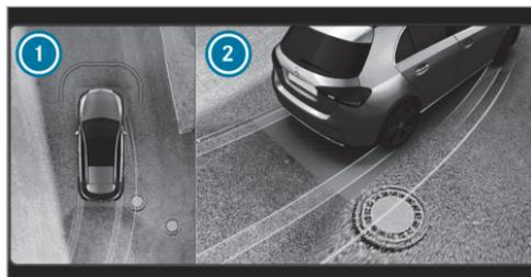
En la vista 3D para el lado izquierdo/derecho del vehículo, la cámara virtual cambia al lado del vehículo correspondiente ②. Al cambiar la posición del cambio, la perspectiva se adapta automáticamente. Adicionalmente, se muestra la Top View ① con la indicación de advertencia de la ayuda para aparcar PARKTRONIC.
