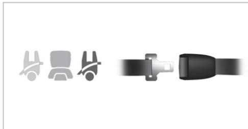
Con el vehículo encendido, la indicación de estado de los cinturones de seguridad traseros muestra durante un tiempo determinado qué cinturón de seguridad trasero no está abrochado.
