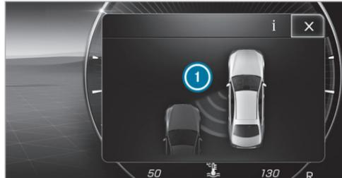
Si se produce una intervención en el freno para corregir la dirección, parpadea el testigo luminoso de advertencia rojo del retrovisor exterior y suena una señal acústica de advertencia. Adicionalmente se muestra una indicación ① en el visualizador del conductor que indica el peligro de colisión lateral.
