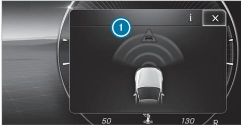
Si se ha realizado un frenado autónomo o se ha activado la amplificación de la fuerza de frenado
