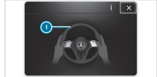
Si el sistema detecta que el conductor no gira el volante o que retira las manos del volante durante cierto tiempo, se emite la indicación 1. Si el conductor sigue sin mover el volante de forma activa, además de la advertencia óptica suena una señal acústica de advertencia.
