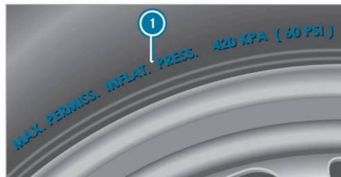
**i** Los datos de la ilustración son ejemplos. Nunca se debe sobrepasar la presión máxima admisible del neumático **1** para la que el neumático está homologado. Al ajustar la presión del neumático, tenga siempre en cuenta la presión recomendada para el vehículo. (→ página 339)
